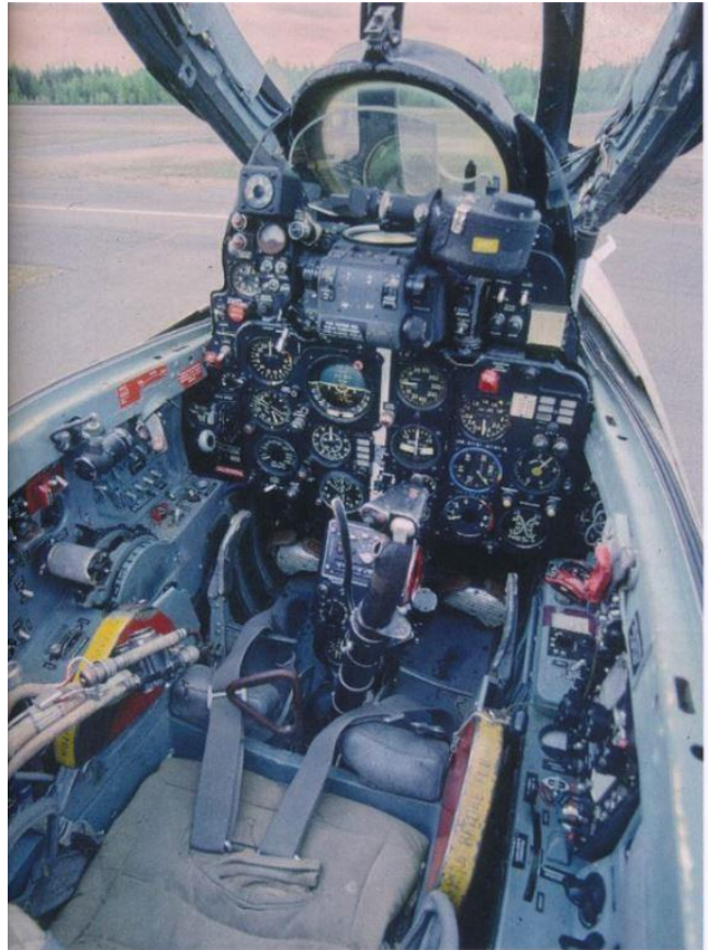
MiG-21F:n hävittäjäversionen ohjaamo. Koneksilö on MG-78. Kuva: Jyrki Laukkanen. Kabinen på jaktversionen av MiG-21F-13 (MG-78). Foto: Jyrki Laukkanen
