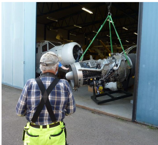
Kjell Lilljehult och Antero T. hämtade en Avon motor från Arlandasamlingarna. Denna motor var monterad på ett av försvarets flygplan Caravelle och som användes för signalspaning.
