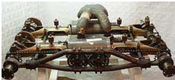
Nybergs unika ångmaskin för drift av dubbla propellrar
