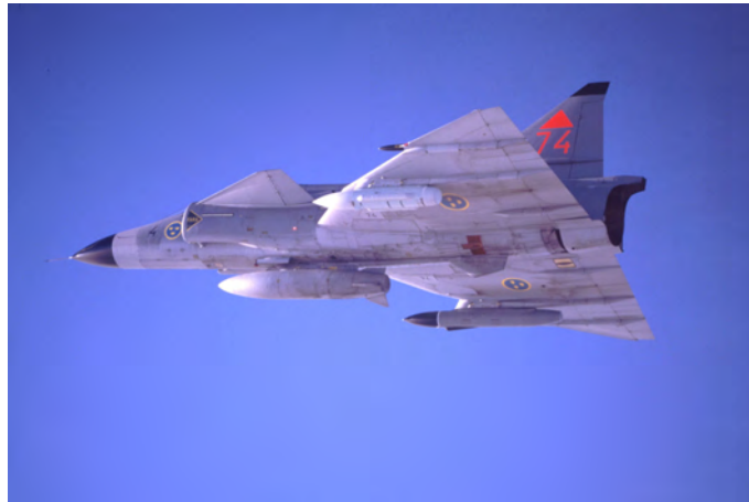
Fpl JA37E med vingplacerade varnare (App73, störsändare U22/A, U95 och störsändare G24 i nosen.)
