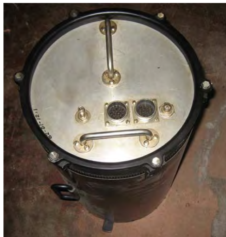
Zonrörsstörsändare för fpl32. Prototyp
